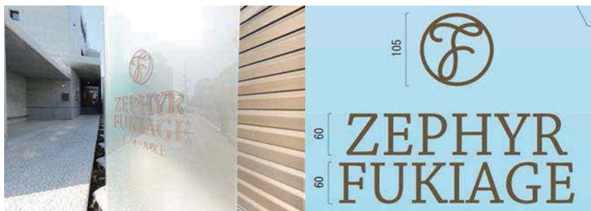
右がサインイメージ。アクリルの切り抜きの出来上がりが左写真。
