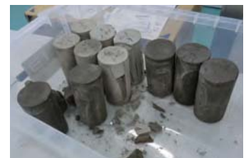
供試体による強度試験。
