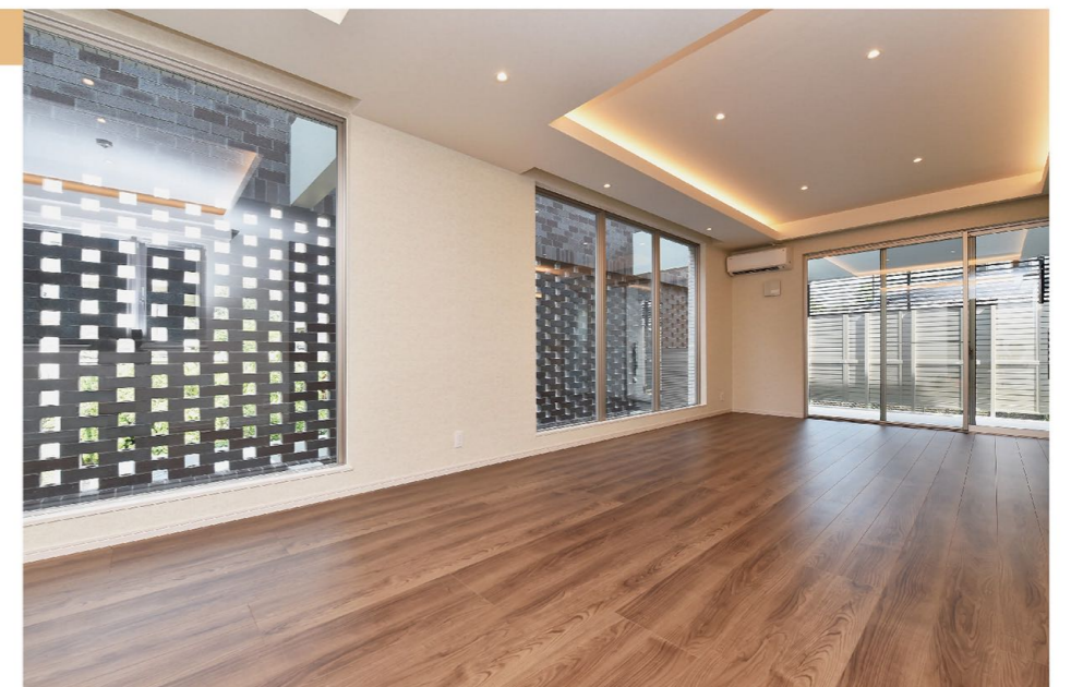
透かし積みレンガのスクリーンにより、周囲の視線を遮りつつ大窓が開放感を生み出す
